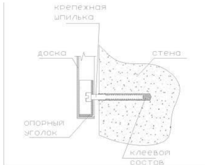
Рисунок 1. Схема установки шпильки.
